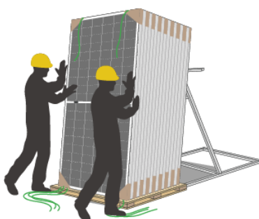
8) Odřízněte zbývající balicí pásy tak, aby moduly spočívaly na podpěře stojanu.
