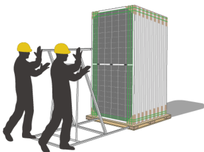
4) Umístěte podpěru stojanu ze strany skla nebo zadního listu.
