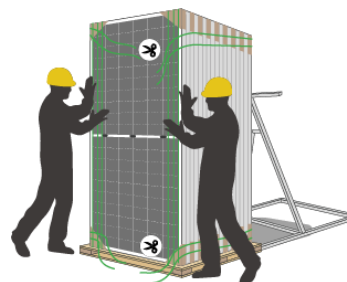
6) Odřízněte všechny vodorovné balicí pásy.
