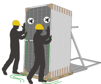
4) Umístěte podpěru stojanu ze strany skla nebo zadního listu.
